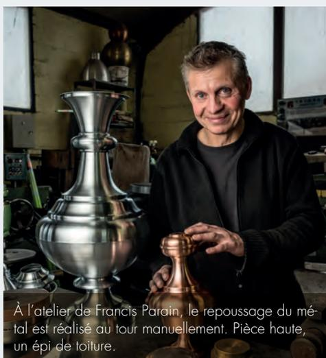
À l'atelier de Francis Parain, le repoussage du métal est réalisé au tour manuellement. Pièce haute, un épi de toiture.
